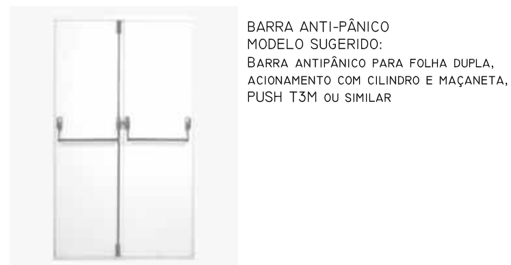
4 ESPECIFICAÇÃO DA BARRA ANTIPÂNICO SEM ESCALA
