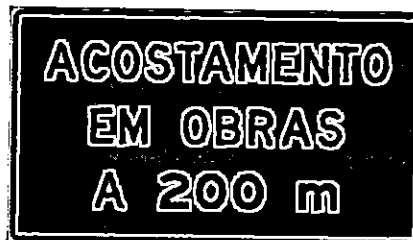
Figura 4-6 - Sinal de acostamento em obras a ..... metros
